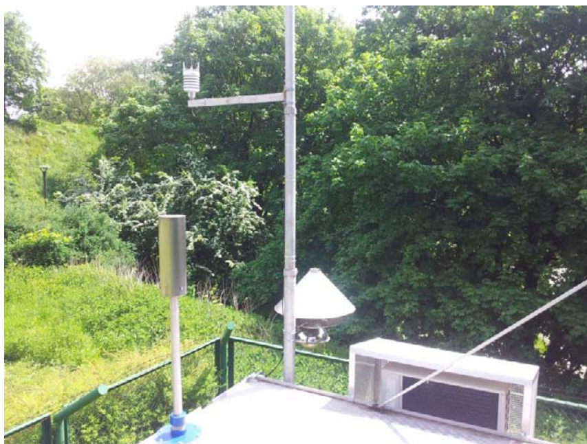
Ryc.3 Stacja pogodowa Vaisala WXT 520 na stacji AM1 Gdańsk Śródmieście
